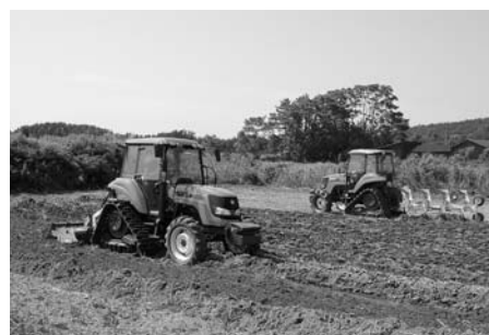
プラウによる耕起とバーチカルハローの整地作業
