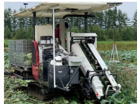
開発中のキャベツの自動収穫機
